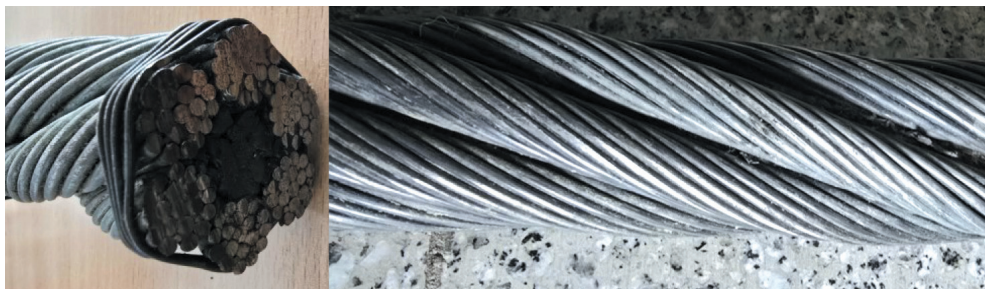
Rys. 1. Przekrój poprzeczny i powierzchnia liny o konstrukcji spletek 6×36WS
