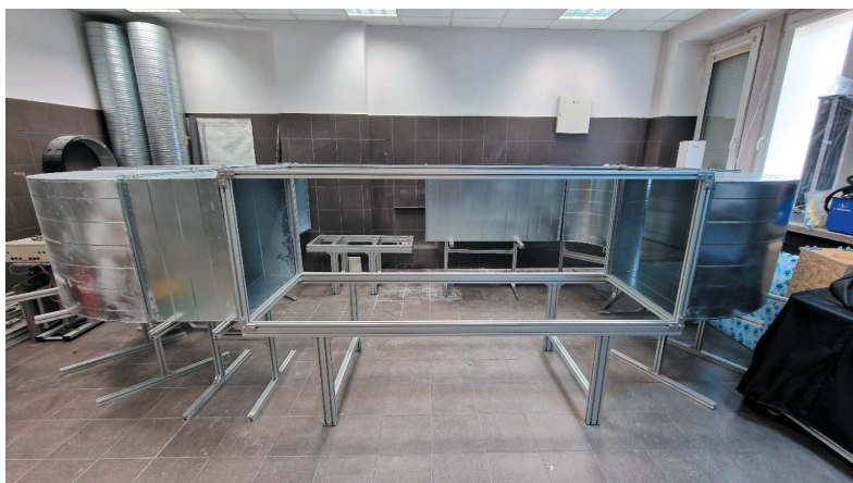
Rys. 5. Sekcja testowa tunelu aerodynamicznego ze zdemontowanymi wypełnieniami ścian bocznych
