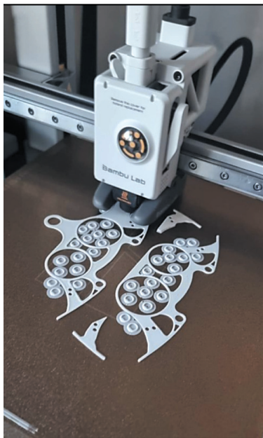
Rys. 10. Rzeczywisty prototyp geometrii korpusu zacisku hamulcowego wykonany z tworzywa sztucznego (PLA) w technologii druku FDM: a) w trakcie druku; b) gotowy element
