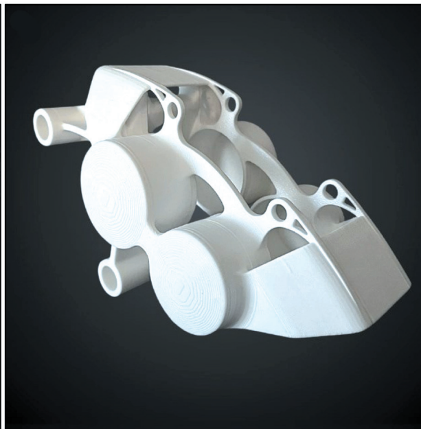
Rys. 10. Rzeczywisty prototyp geometrii korpusu zacisku hamulcowego wykonany z tworzywa sztucznego (PLA) w technologii druku FDM: a) w trakcie druku; b) gotowy element
