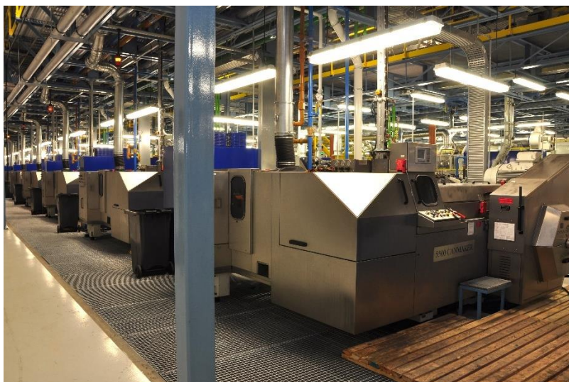
Rys. 4.2 Prasy poziome (ang. bodymaker) ustawione równolegle na linii produkcyjnej
