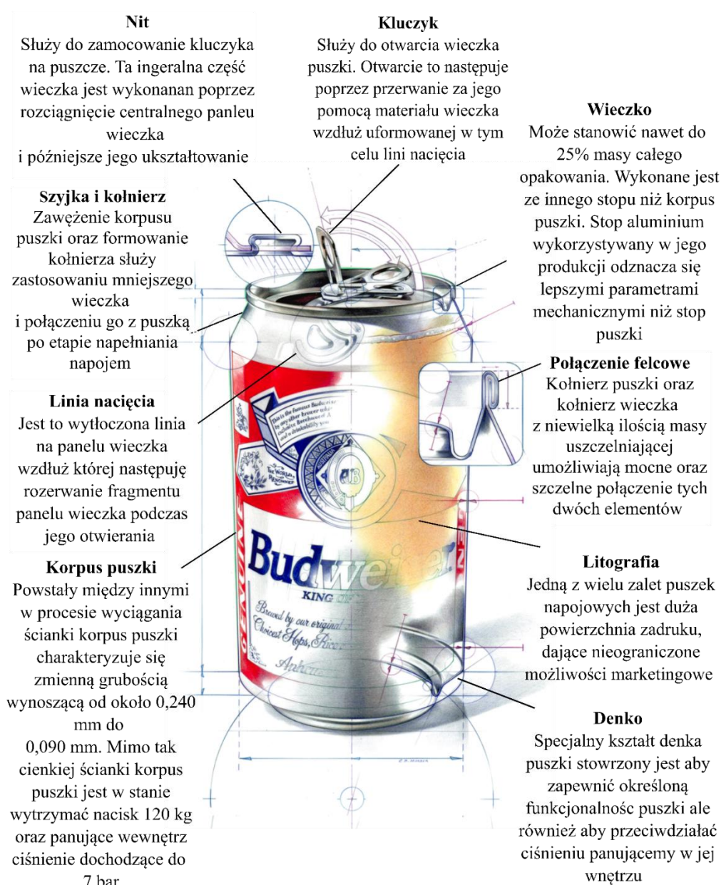
Rys. 3.1 Budowa aluminiowej puszki napojowej [18]
