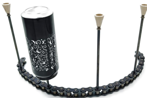
Rys. 5.2 Fragment łańcucha pinowego z pieca PIN do suszenia litografii zewnętrznej
