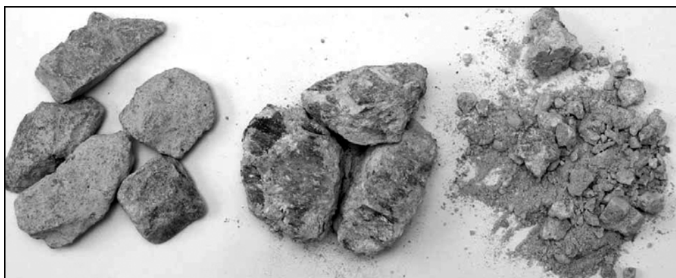
Rys. 4. Chińska ruda złota przed rozdrobnieniem (z lewej), po rozdrobnieniu w HPGR (w środku), po ściśnięciu płatków w palcach (z prawej) (fot. T. Gawenda)
