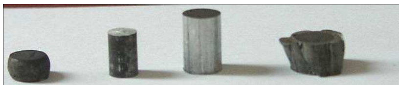
Rys. 32. Próbki przygotowane z materiału PNC (od lewej): ściskana na gorąco 460\text{C} , próbka do ściskania na gorąco, próbka do ściskania na zimno, próbka ściskana w temperaturze pokojowej.
