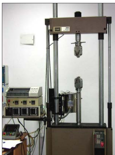
Rys. 31. Maszyna wytrzymałościowa MTS 880 wraz z piecem
