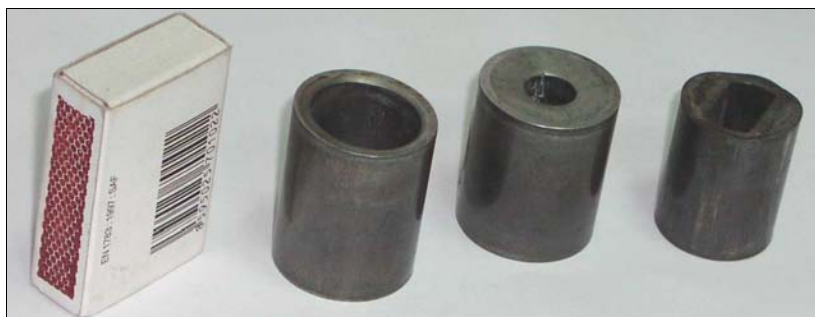
Rys. 30. Tłoczki wykonane z materiału PNC metodą kucia na gorąco
