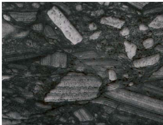
Fig. 9. Obraz mikroskopowy gipsowego żwiru piaszczystego utworzonego z ostrokrawędzistych okruchów mioceńskiego gipsu laminowanego (z górnej części profilu gipsowego). Kamieniołom w Gackach. Powiększenie 2×
