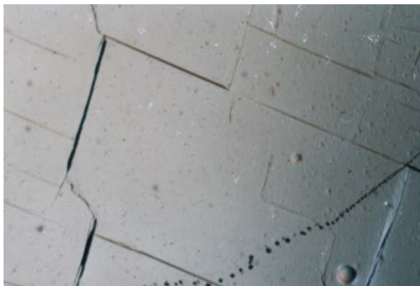
Fig. 10. Deformacja kryształów halitu w wyniku metamorfizmu diastroficznego. Orientacja wrostków gazowo-ciekłych (prawy dolny róg fot.) o przebiegu niezgodnym z łupliwością halitu o wydłużonych blastach. Wieliczka, sole najstarsze. Mikroskop polaryzacyjny, polaroidy częściowo X, powiększenie 80×
