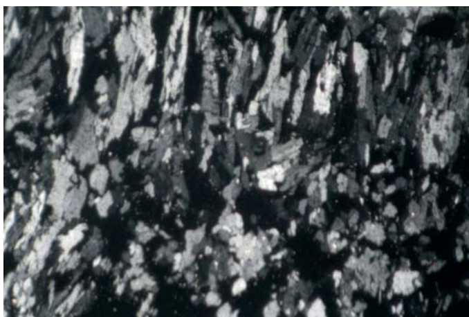
Fig. 5. Obraz mikroskopowy pierwotnego gipsu laminowanego. W dolnej partii gips drobnokrystaliczny – lamina ciemna. W górnej partii gips nieco grubiej krystaliczny – lamina jasna. Gipsy mioceńskie. Światło spolaryzowane, nikole X, powiększenie 10×
