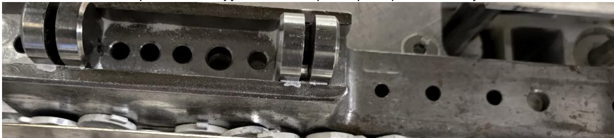
Rysunek 5.11. Zdjęcie otworów wykonanych w podstawie stacji 1
