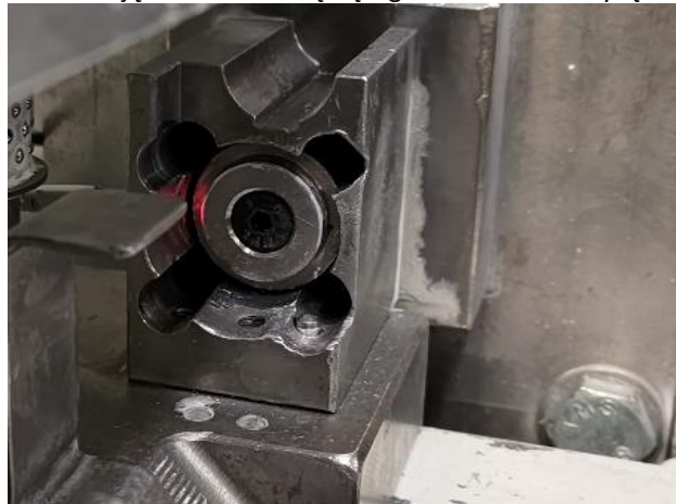
Rysunek 5.10. Zdjęcie elementu łączącego siłownik z matrycą na stacji 3.
