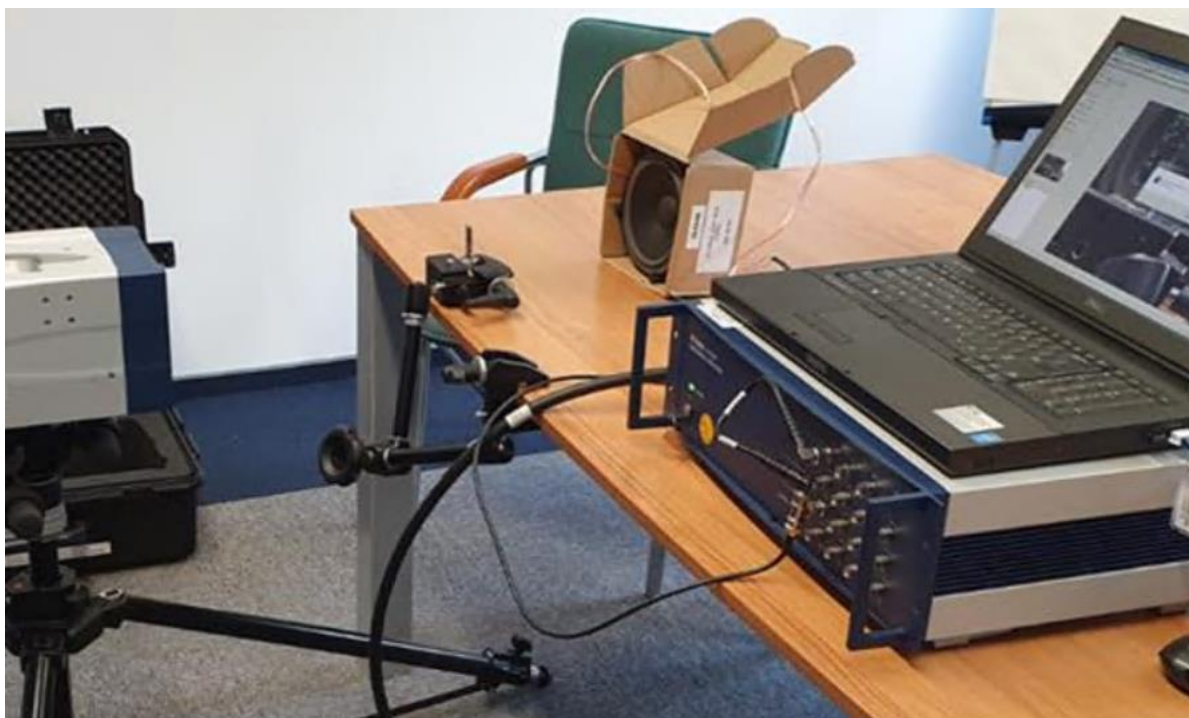
Rysunek 5.5: Konfiguracja eksperymentu przy użyciu wibrometru laserowego Polytec PSV400
