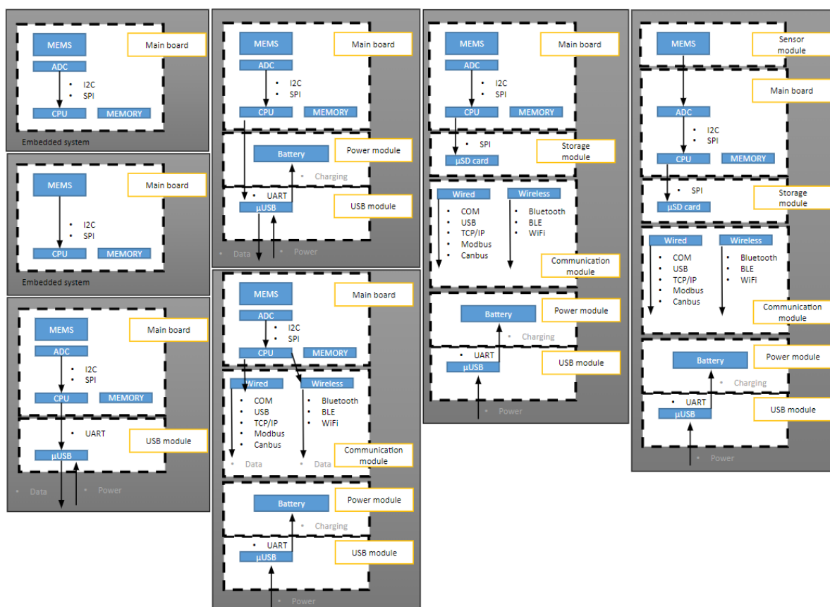
Rysunek 4.1: Przykłady architektury urządzenia wbudowanego, mającej kluczowy wpływ na przyszłą funkcjonalność CMS
