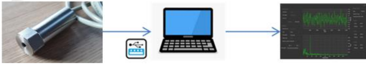
Rysunek 7.6: Schemat prototypowego układu akwizycji danych
