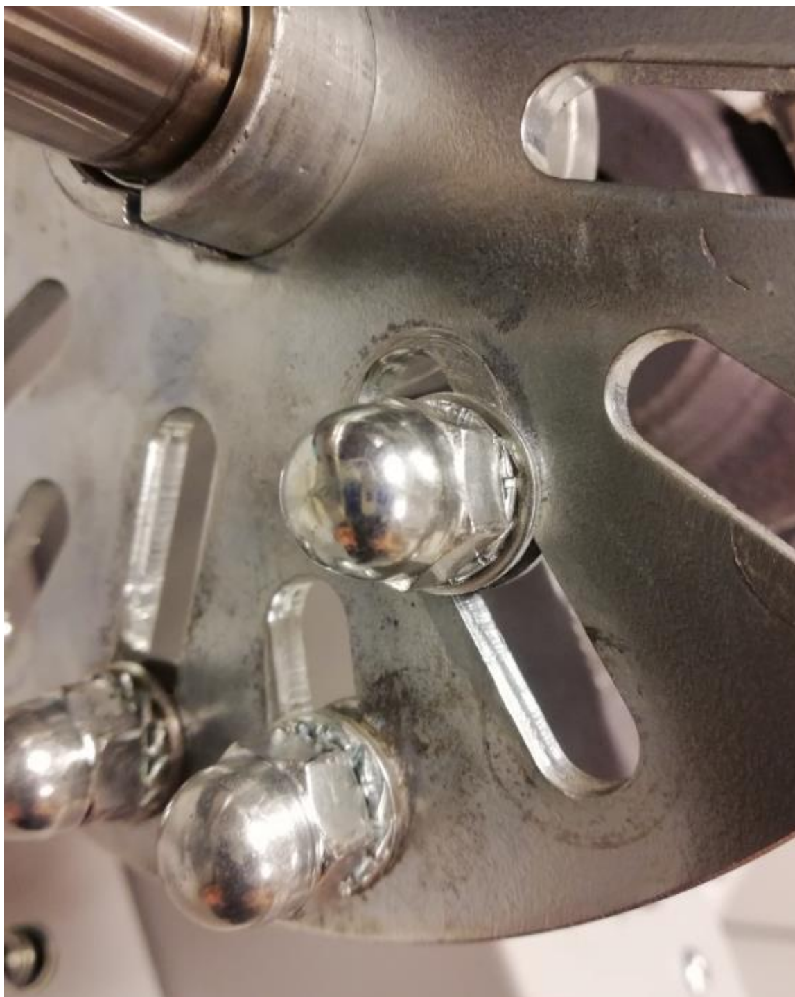
Rysunek 7.3: Tarcza ze śrubami wprowadzającymi niewyrównowazenie na wale wyjściowym stanowiska
