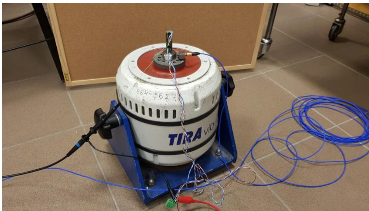
Rysunek 5.8: Konfiguracja eksperymentu przy użyciu wzbudnika TIRAvib TV51144
