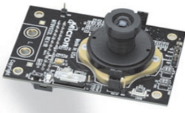
Rys. 2. Sensor wizyjny wraz z obiektywem
