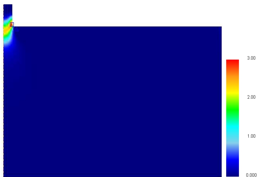
Rys. 72. Rozkłady odkształcenia \varepsilon_y dla współczynnika wydłużenia \lambda = 600 .
