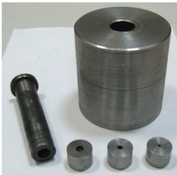
Rys. 76. Zestaw narzędzi do wyciskania przeciwbieznego.
