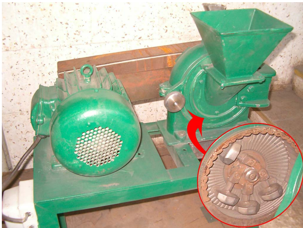
Rys. 4.3. Laboratoryjna kruszarka młotkowa wraz z widokiem komory roboczej
