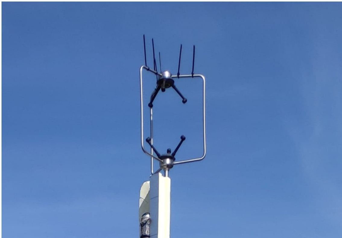
Rysunek 7: Przykład anemometru akustycznego wykonującego pomiary w trzech płaszczyznach.
