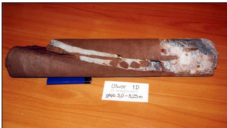
Rys.14.1. Rdzeń wiertniczy przedstawiający zainiekowaną skałę
