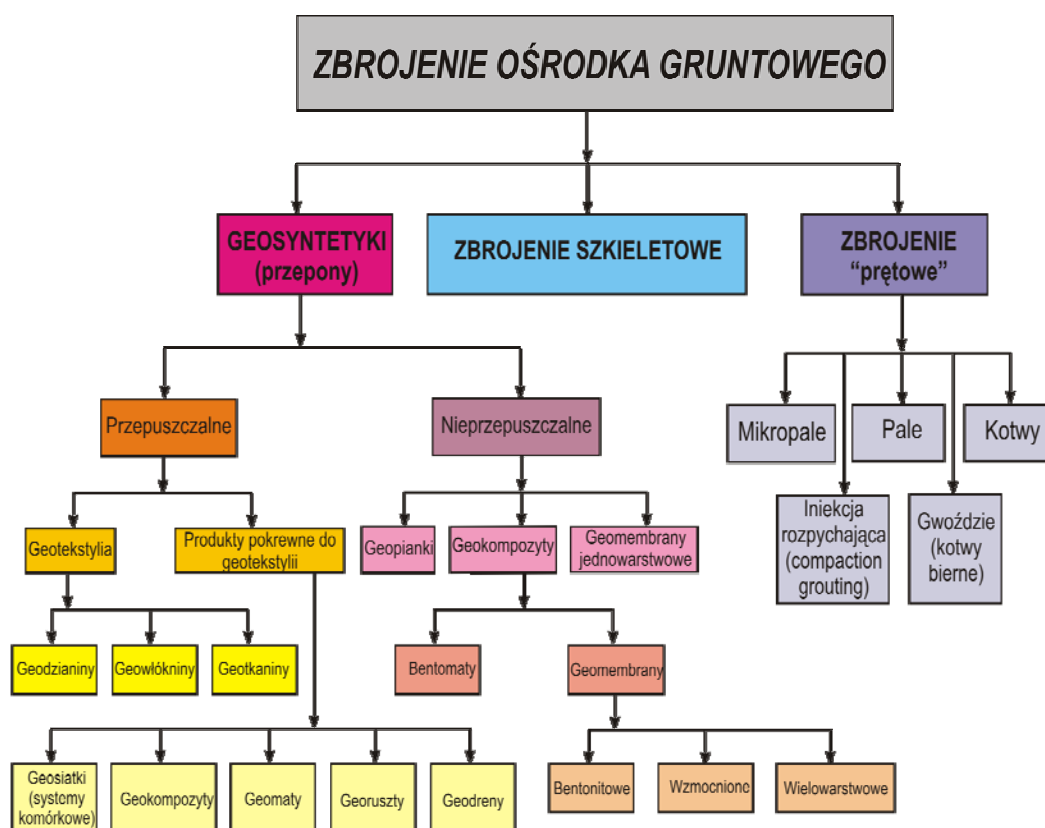
Rys. 15.8. Klasyfikacja typów zbrojenia ośrodka gruntowego [82; 84; 85]
