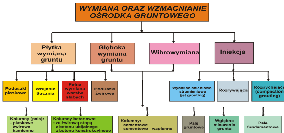
Rys. 15.6. Klasyfikacja metod wymiany oraz wzmocniania ośrodka gruntowego [82; 85]
