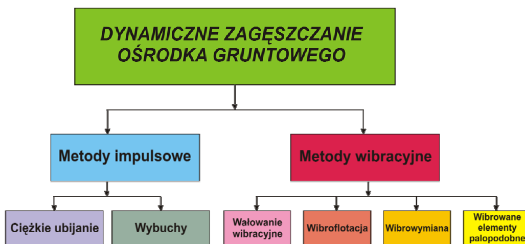
Rys. 15.1. Klasyfikacja metod dynamicznego zagęszczania gruntów [82; 84; 85]
