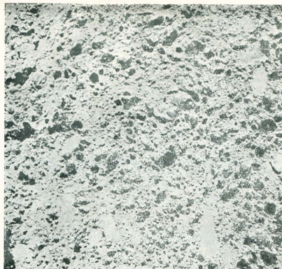
Rys. 7. Koks L. I. Porowatość 43,62%.
