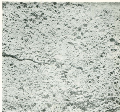
Rys. 8. Koks L. II Porowatość 48,98%.
