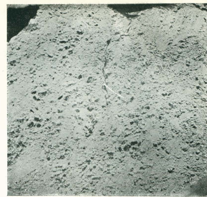
Rys. 14. Koks L. XIII. Porowatość 39,28%.
