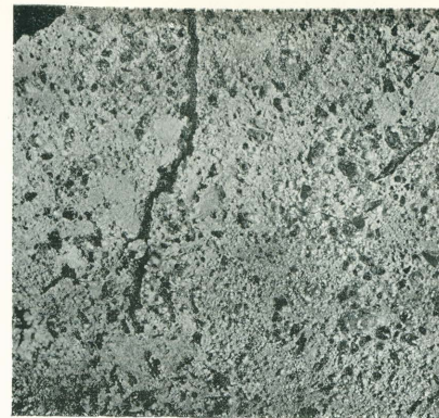
Rys. 13. Koks L. XII. Porowatość 49,32%.
