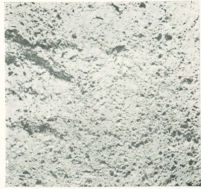
Rys. 12. Koks L. XI. Porowatość 44,86%.
