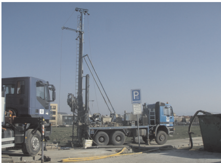
Rys. 4. Wiertnica NORDMEYER DSB 2/10 podczas prac wiertniczych na Małym Poligonie Badawczym
