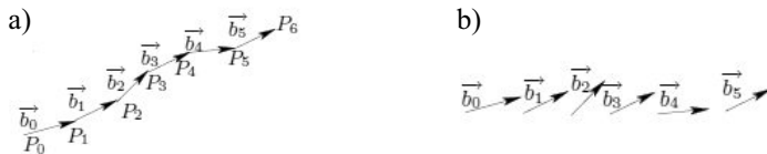
Rys. 4. Krzywa wolumetryczna r składająca się z kolejnych punktów P_0, P_1 \dots P_6 oraz odpowiadających im wektorów b_1, b_2 \dots b_5 reprezentujących kierunek stycznej w kolejnych punktach (a), zbiór wszystkich wektorów kierunku stycznej (b) [10]
