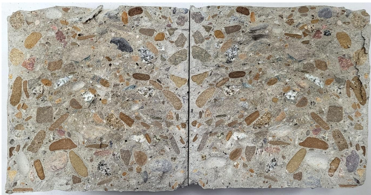
Rys. 4.19. Obraz powierzchni zniszczenia kontrolnej próbki sześciennej po badaniu wytrzymałości na rozciąganie przy rozłupywaniu
