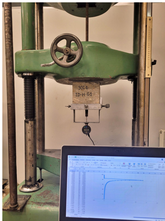
Rys. 4.15. Widok stanowiska do badania przyczepności metodą pull-out
