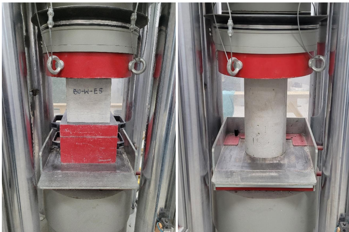
Rys. 4.13. Przykładowa próbka podczas badania wytrzymałości na ściskanie: a) sześcienna, b) walcowa
