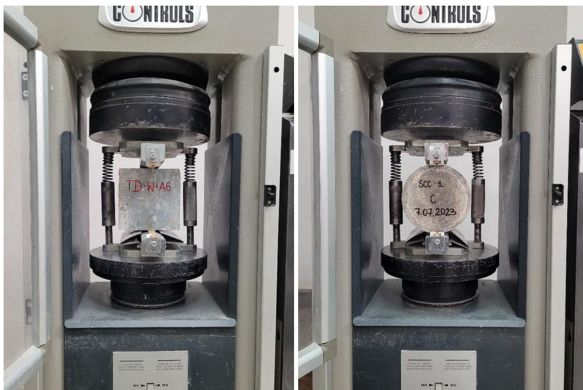
Rys. 4.14. Przykładowa próbka podczas badania wytrzymałości na rozciąganie przy rozłupywaniu: a) sześcienna, b) walcowa
