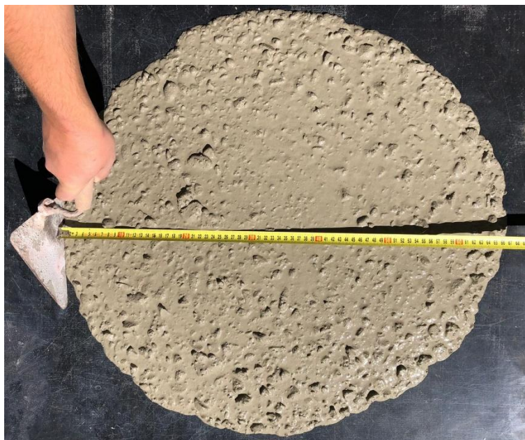
Rys. 4.18. Widok mieszanki A po badaniu rozptywu stożka
