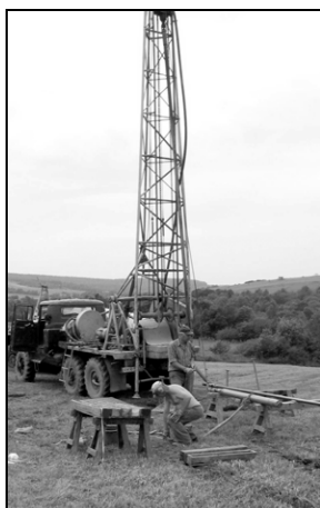
Rys. 1. Wiercenia rdzeniowe \varnothing 132 mm, Beskid Niski
