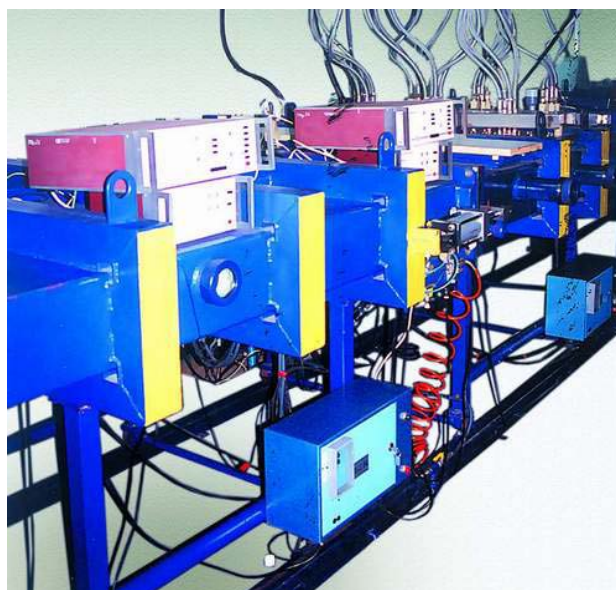
Rys. 1.1. Fragment linii technologicznej do magnetronowego nanoszenia warstw na wielkoformatowe tafle szklane zainstalowanej w rzeszowskiej firmie Maryland
