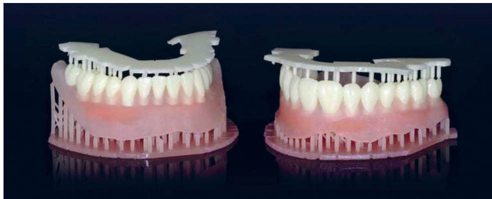
Rys. 10. Protezy dentystyczne wykonane metodą druku 3D
