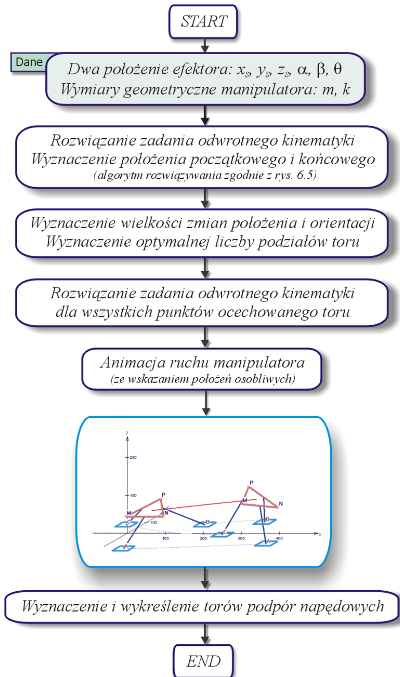
Rys. 7.12. Algorytm programu „Triplanar – Dwa położenia”
