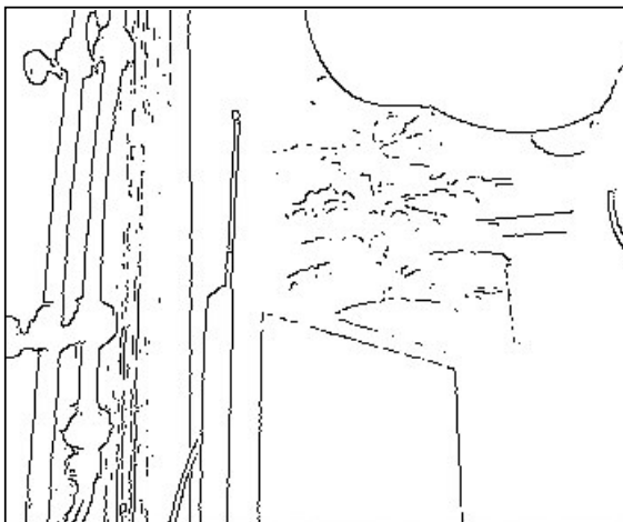
Rys. 2. Wynik działania algorytmu Canny ( P_g = 158 , P_d = 165 , R_{ms} = 3 ) dla obrazu z rysunku 1
