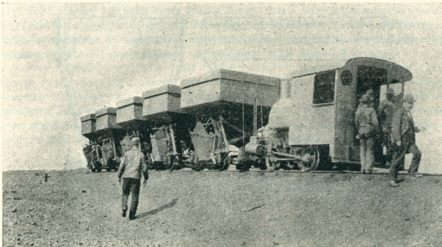
Rys. 104. Pociąg z wagonami do ładowania pieców ulowych w Pensylwanji.
