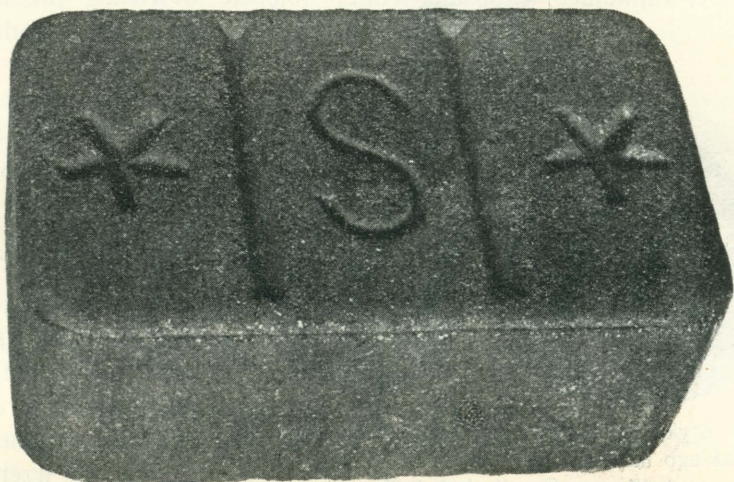
Rys. 46. Brykiet z węgla kamiennego, ważący 10 kg, używany w marynarce (1:3,5)
