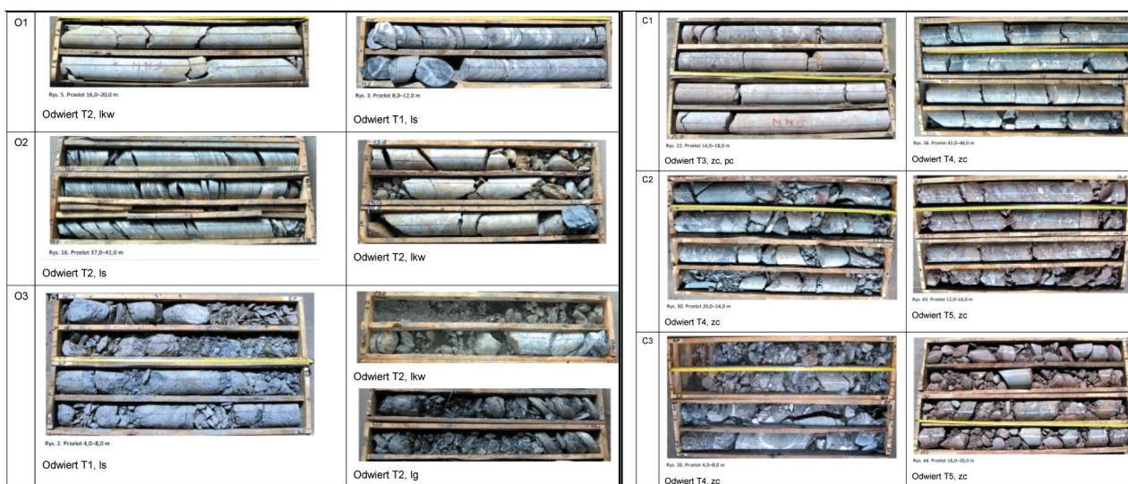
Rys. 2. Typowy wygląd rodzajów gruntów O1, O2 oraz O3 (po lewej), oraz C1, C2 i C3 (po prawej) w rdzeniach odwiertów [3]
