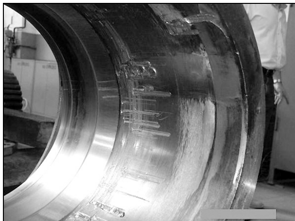
Rys. 1. Ślady uszkodzeń powierzchni dociskowej jarzma przekładni po demontażu
