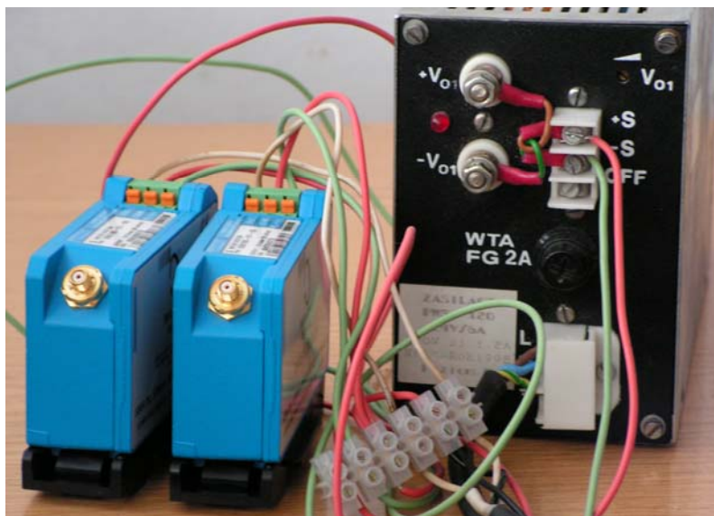
Rys. F.9. Układ zasilania przetwornika czujnika wiropądowego
