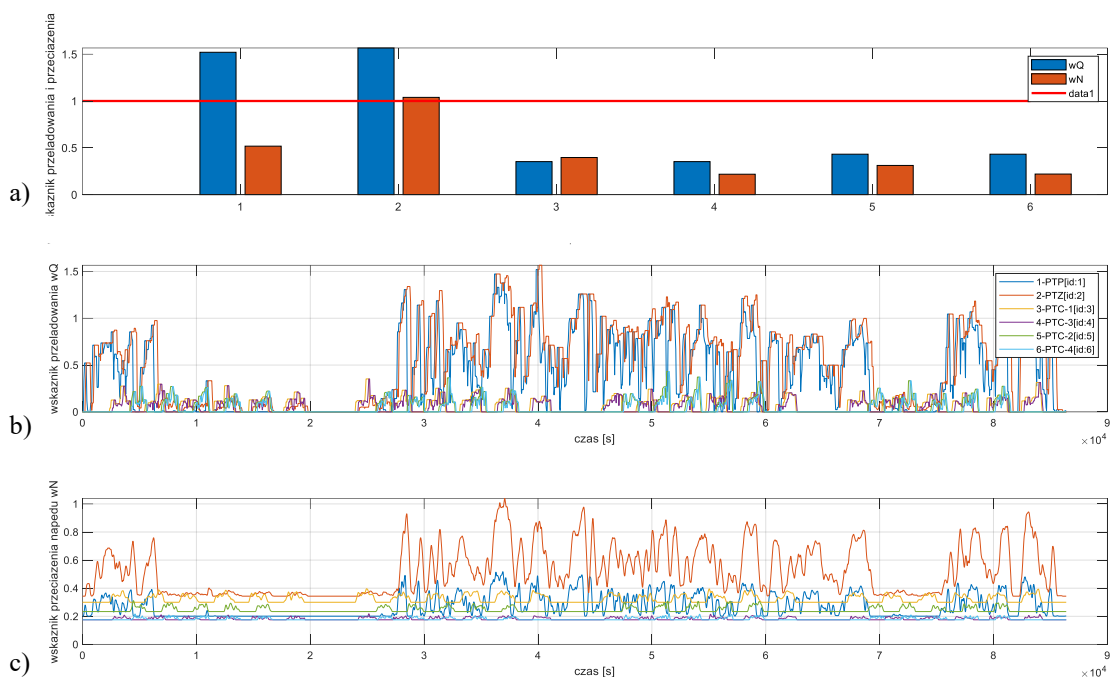
Rys. 7.2.10 Wartości wskaźnika przeładowania i przeciążenia przenośników podczas badań symulacyjnych dla wariantu 1
