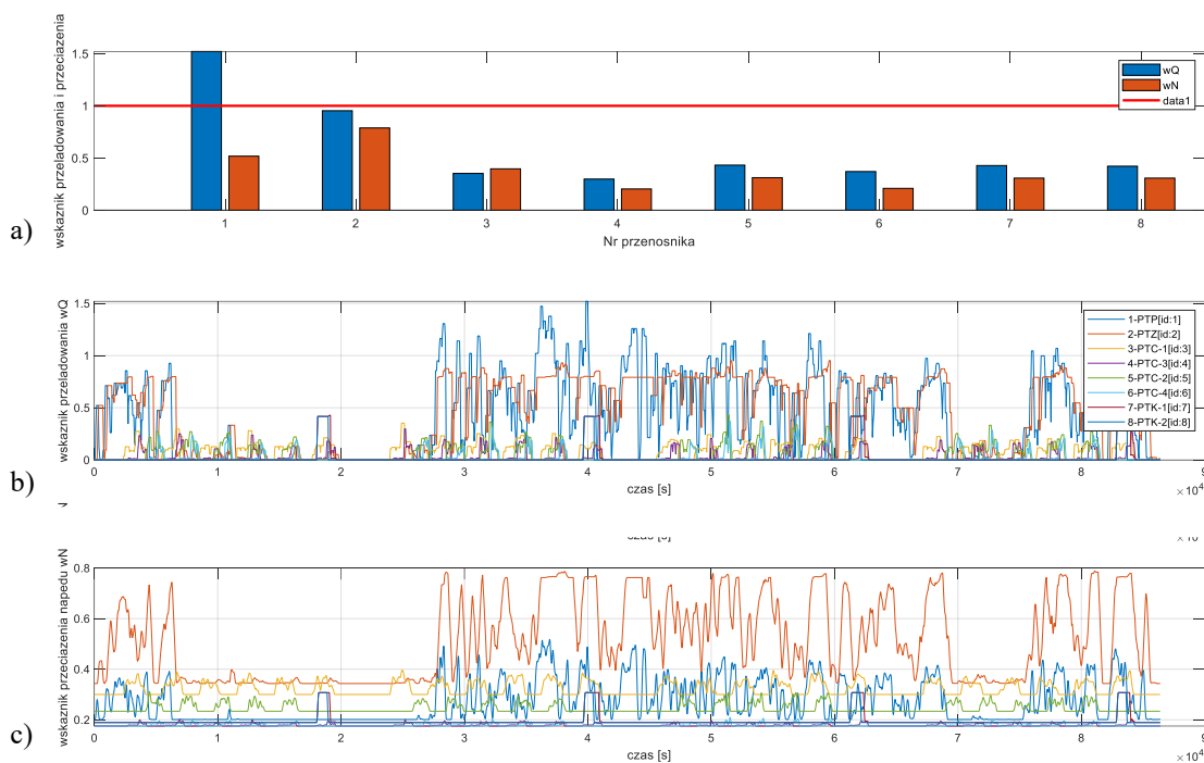
Rys. 7.2.15 Wartości wskaźnika przeładowania i przeciążenia przenośników podczas badań symulacyjnych dla wariantu 3
