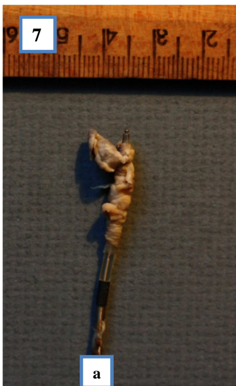
Fig 27. Zdjęcie makroskopowe elektrody 7
