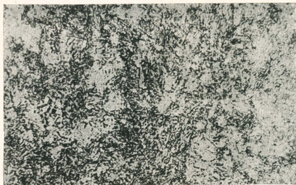
Mikrofotografia Nr. 11, termicznie ulepszona zastępczo, 4" hartowana, pow. \times 500 .
