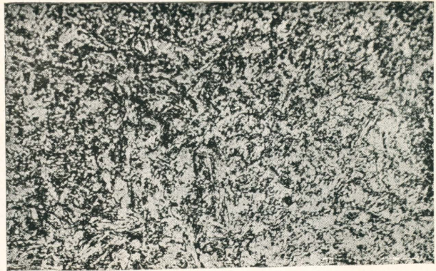
Mikrofotografia Nr. 6, zahartowana, pow. \times 500 .
