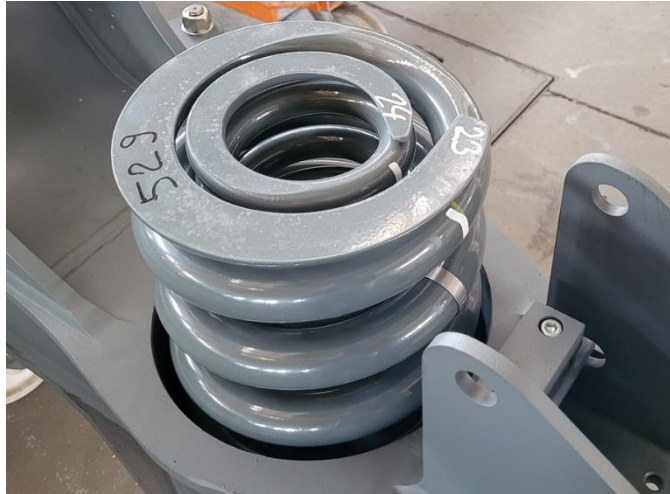
Rys. 2.5. Wzajemne ustawienie sprężyn w gnieździe wózka kolejowego (Górowski, 2021)
