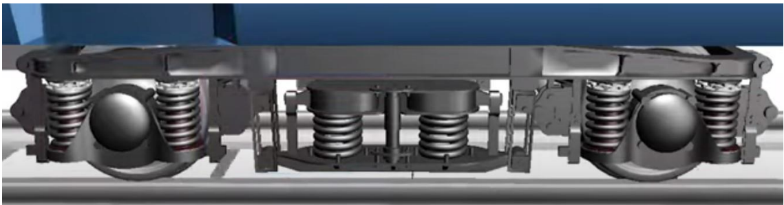
Rys. 2.8. Zawieszenie wózka kolejowego z czterema zestawami sprężyn na drugim stopniu (Let's Grow Up, 2021)
