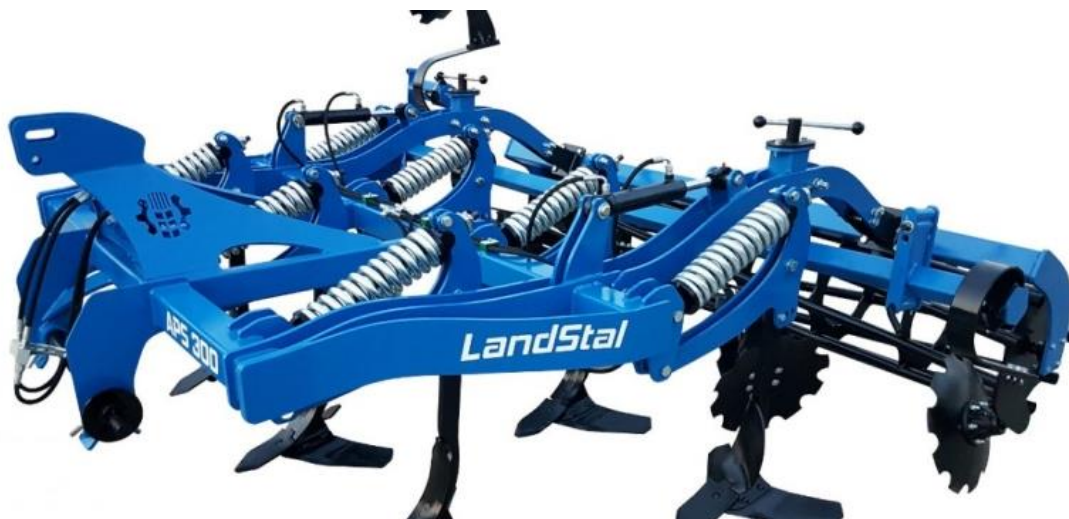
Rys. 2.15. Agregat podorywkowy APN firmy LandStal z zastosowanymi pakietami podwójnych sprężyn naciskowych (Krismar)
