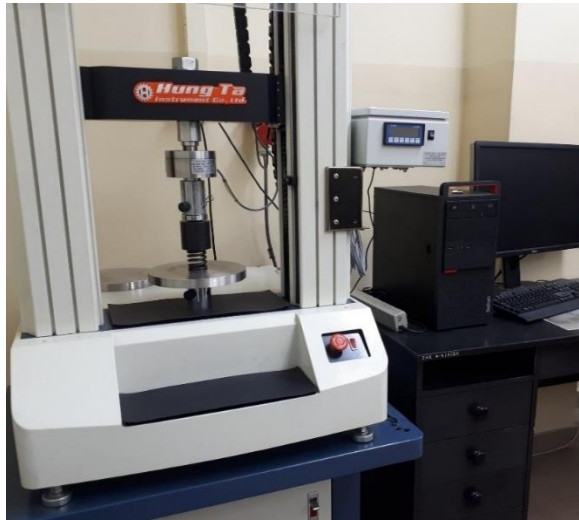
Rys. 4.7. Stanowisko badawcze do pomiaru sztywności osiowej (Baran, Michalczyk, Warzecha, 2025)
