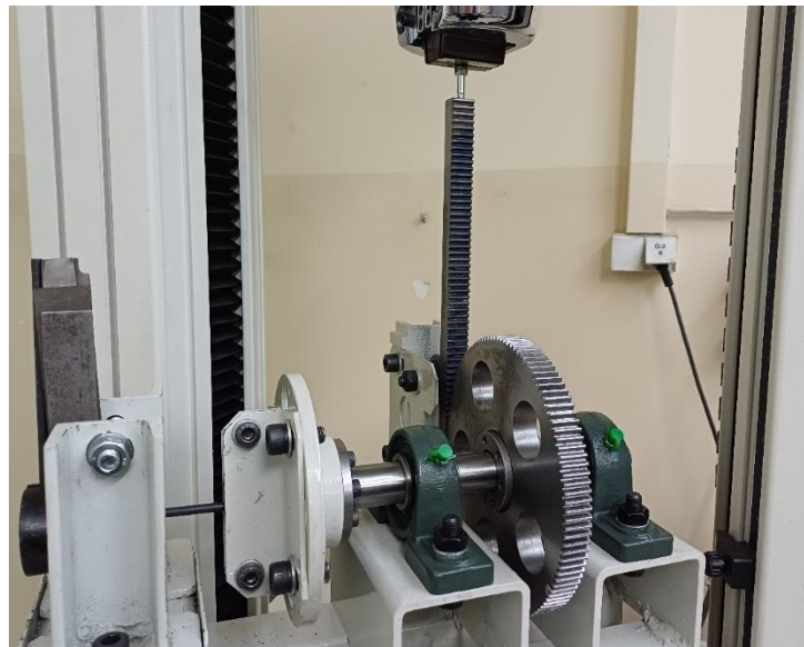
Rys. 4.4. Przyrząd do badania Modułu Kirchhoffa zamocowany w maszynie wytrzymałościowej HT-2402 Hung Ta Instrument Co., LTD., Taiwan (Baran, Michalczyk, Warzecha, 2025)
