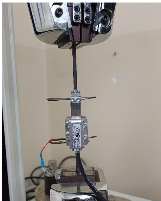
Rys. 4.5. Pomiar Modułu Younga na maszynie wytrzymałościowej HT-2402 Hung Ta Instrument Co., LTd., Taiwan, wyposażonej w ekstensometr ZEPWN CL25D-R B50 L30 (Baran, Michalczyk, Warzecha, 2025)
