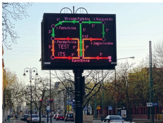
Rys. 2. Przykładowa tablica zmiennej treści inteligentnego systemu
