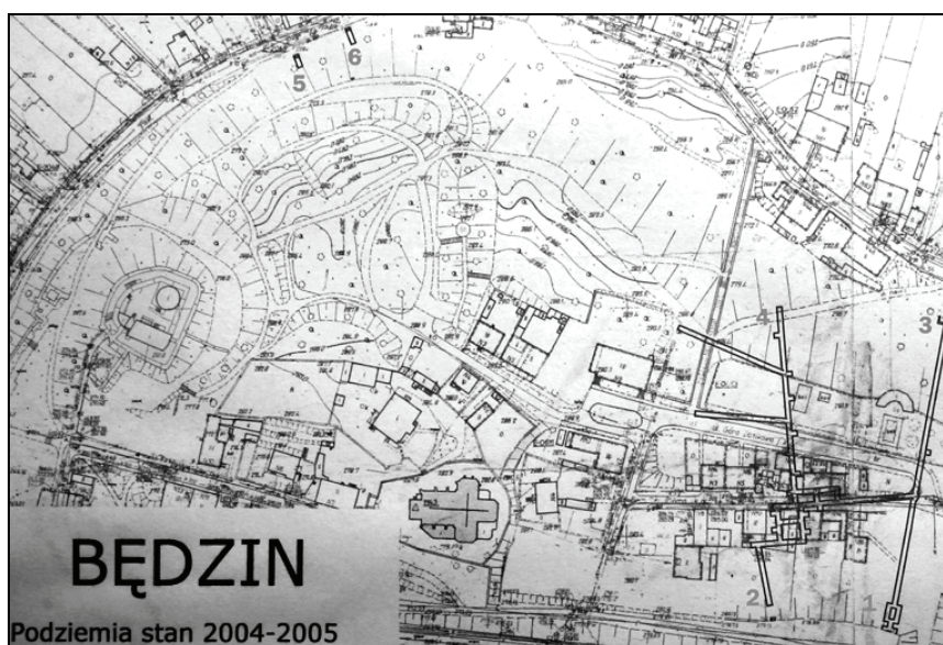
Rys. 3. Lokalizacja podziemnych budowli na wzgórzu zamkowym (rys. Janusz Mieduniec). 1, 2, 3, 4 — wyloty połączonego kompleksu chodników; 5, 6 — wyloty niezależne
