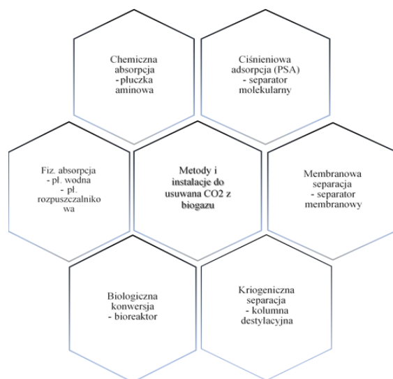
Rysunek 4.4. Metody uzdatniania biogazu w zakresie usuwania dwutlenku węgla (źródło: Kurcek, Czarnota, 2020)
