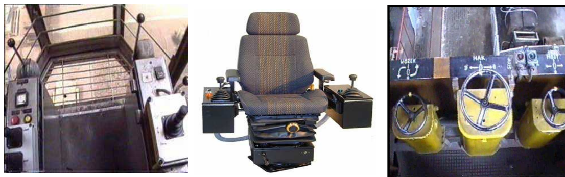
Rys. 5.28. Kabina operatora suwnicy (od prawej): sterownie nastawami rezystorów, ergonomiczne siedzisko operatora, sterowanie z użyciem joystików
