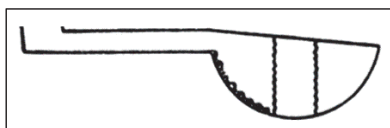
Rys. 61. Kopalnia Laurion, komora w układzie schodowo-spągowym [237]
