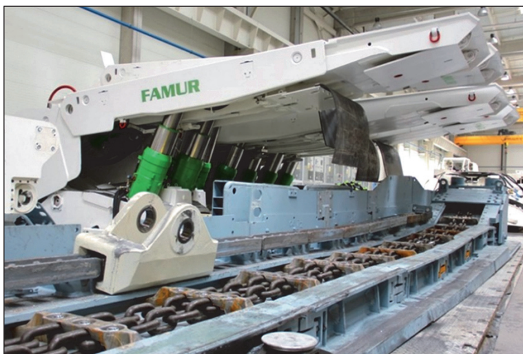
Rys. 310. Obudowa zmechanizowana i przenośnik
