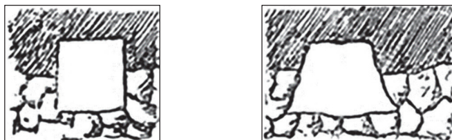
Rys. 60. Kształty wyrobisk korytarzowych w kopalni Laurion [25]
