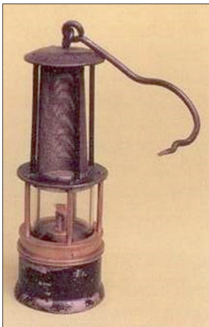
Rys. 376. Współczesna górnicza lampa bezpieczeństwa („wskaźnikowa”)
