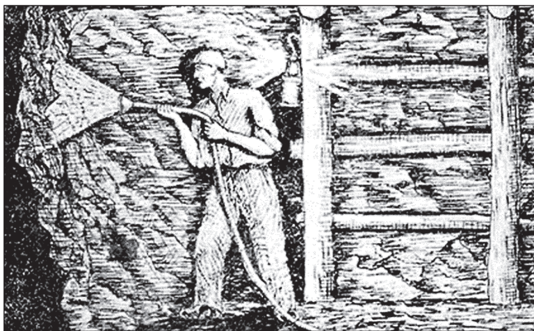
Rys. 379. Zraszanie ociosu wodą (zmywanie nagromadzonego pyłu węglowego) [160]
