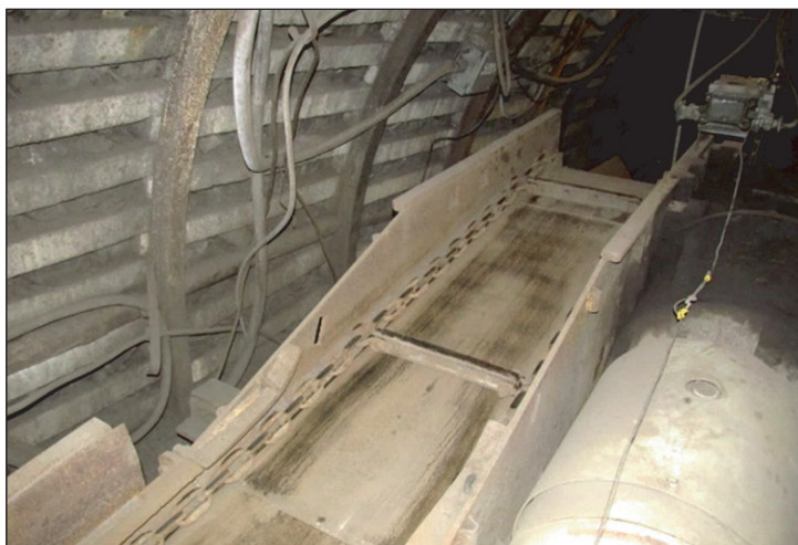
Rys. 294. Przenośnik zgrzeblowy dwułańcuchowy – przesyp – lata 60. XX wieku [112]
