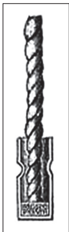
Rys. 176. Słonka z umieszczonym w niej lontem prochowym [160]
