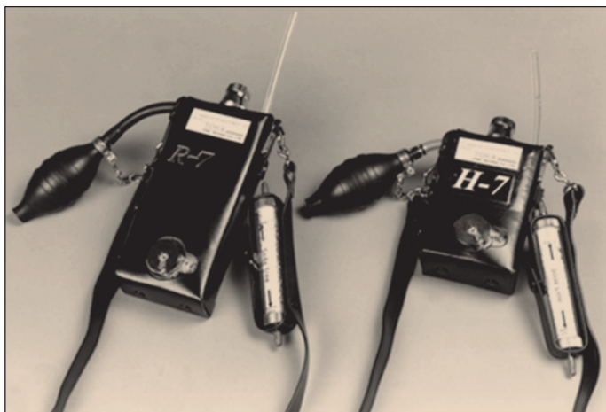
Rys. 377. Metanomierze interferencyjne – koniec XX wieku
