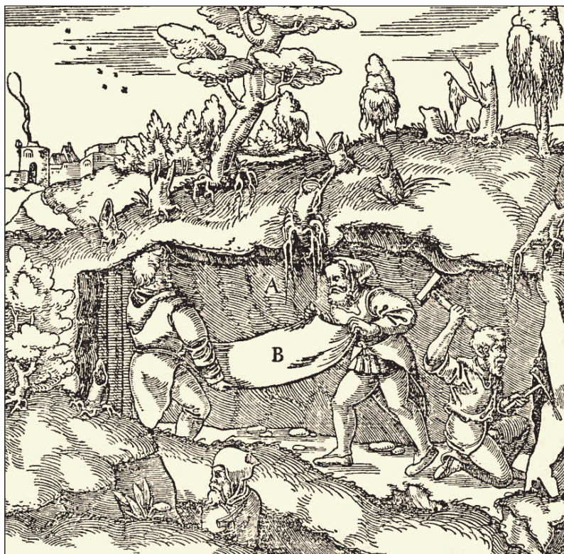
Rys. 108. Przewietrzanie ślepego przodka przy wykorzystaniu płachty [1]
