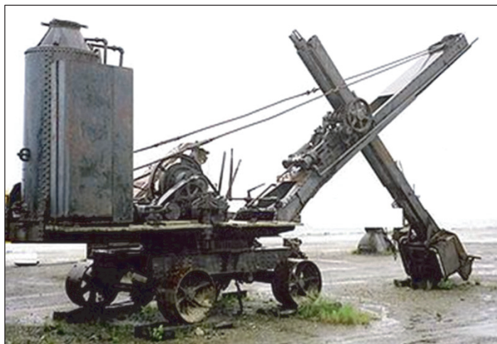
Rys. 394. Jednoślzkowa koparka parowa – połowa XIX wieku [87]
