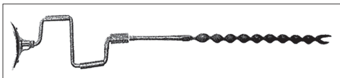
Rys. 188. Świder ręczny do wykonywania otworów strzałowych w węglu – pierwsza połowa XIX wieku [203]
