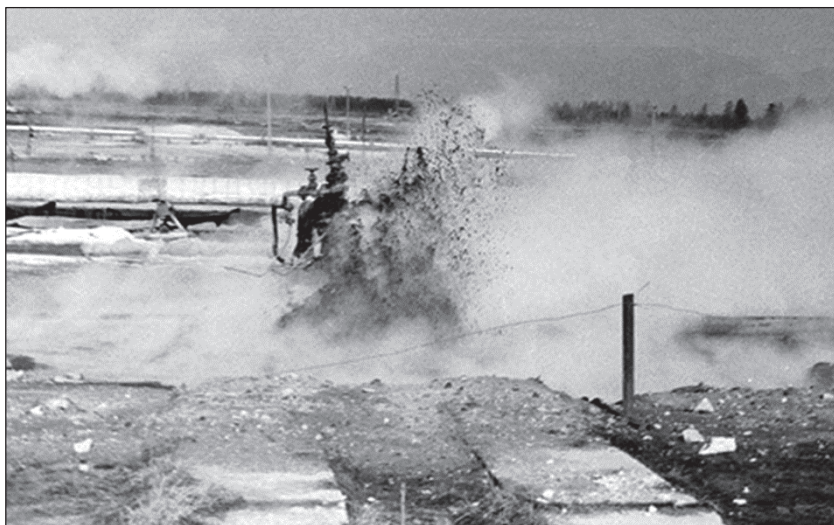
Rys. 349. Erupcja ciekłej siarki z otworu [196]
