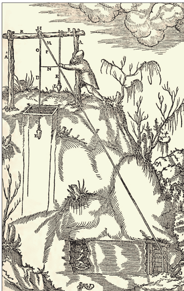
Rys. 116. Sposób przenoszenia kierunku z nadszybia do podszybia [1]
