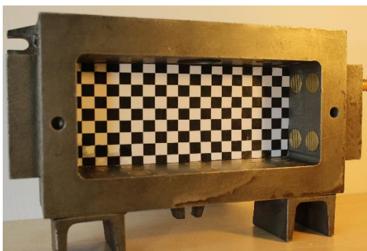
Rys. 17. Jednownikowa rdzennica doświadczalna R-1, stosowana w cytowanych badaniach ruchu strumienia piaskowo-powietrznego w procesie wstrzeliwania masy rdzeniowej [50].
