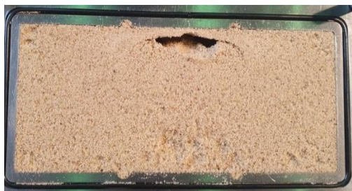
Rys. 81. Fotogram wypełnienia rdzennicy: średnica otworu strzałowego d = 25\text{mm} , podciśnienie 0,0\text{MPa} , czas otwarcia zaworu t = 3\text{s} , stopień odpowietrzenia S_{\text{odp}} = 1,78 , stopień zapełnialności K_{\text{zr}} = 74\% .
