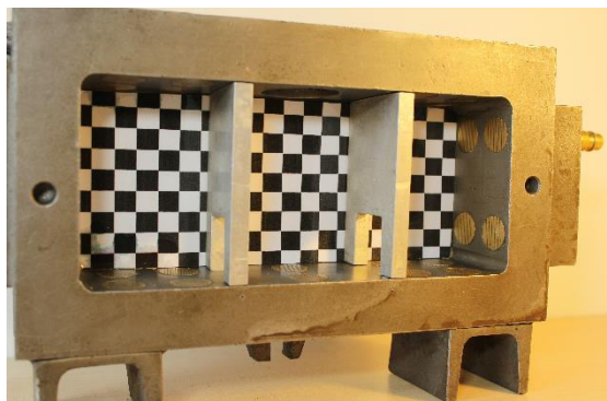
Rys. 11. Wersja trójsektorowej rdzennicy doświadczalnej stosowanej w przykładowych obliczeniach numerycznych przebiegu ciśnienia. Rdzennica ta odpowiada wersji rdzennicy oznaczonej R-4, z wkładkami „G” 2,5\text{ cm}^2 [50].
