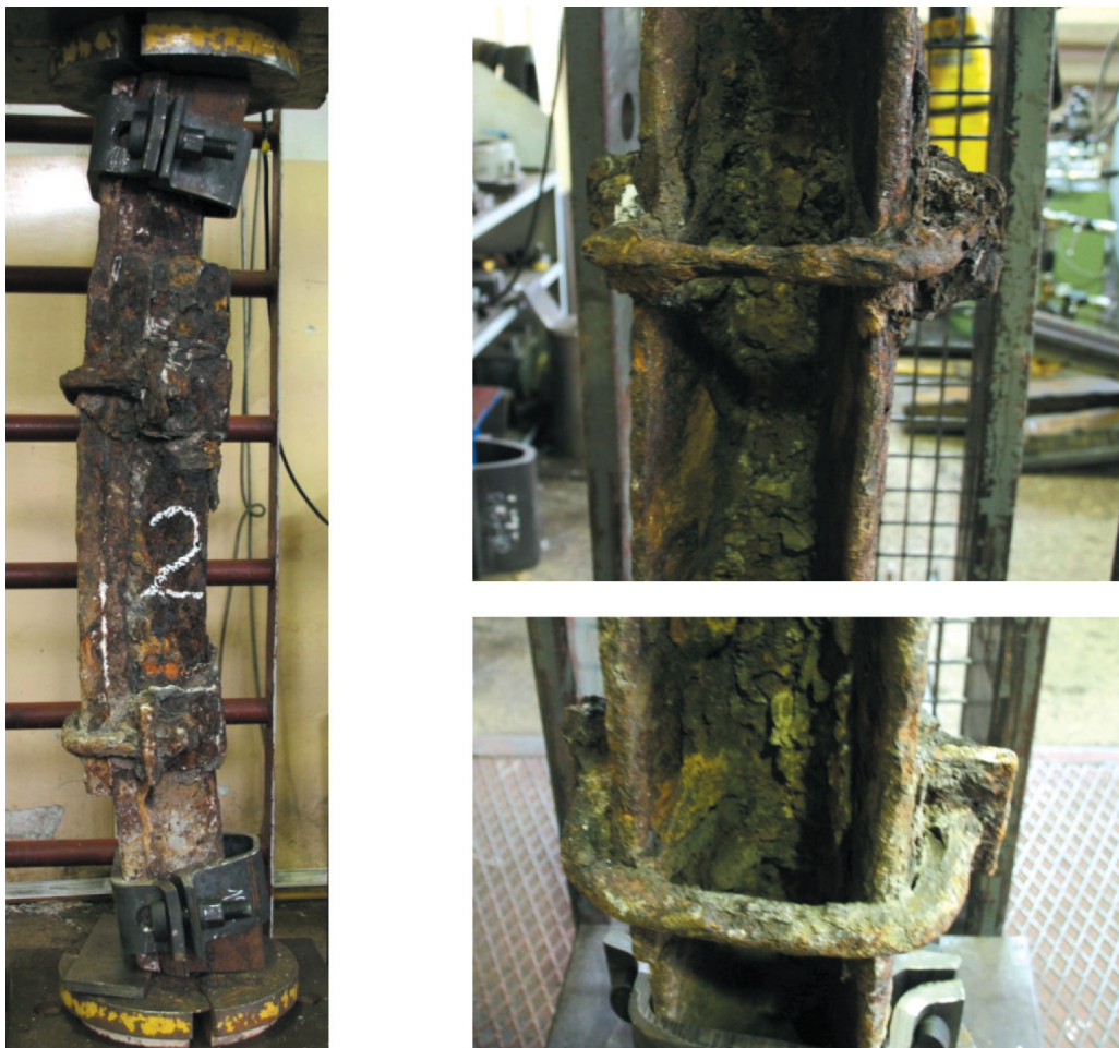
Rys. 4. Złącze cieme 2 przygotowane do badań i stan techniczny strzemion
