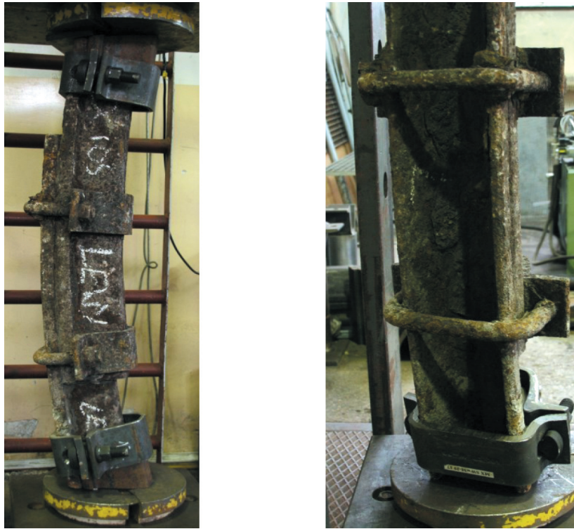
Rys. 3. Złącze cieme 1 przygotowane do badań i stan techniczny strzemion
