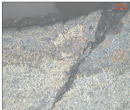
Rys. 5. Wyraźnie zniekształcony profil gwintu w pobliżu pęknięcia w czwartym rowku
