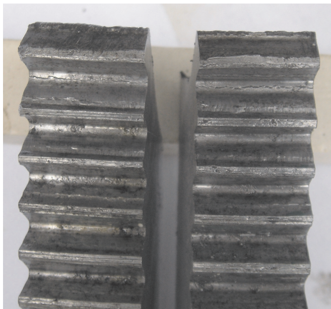
Rys. 10. Pęknięcie czopa wrzeciona w rowku gwintu
