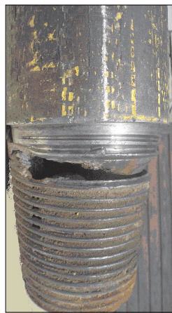
Rys. 9. Częstka stali w gwincie czopa
