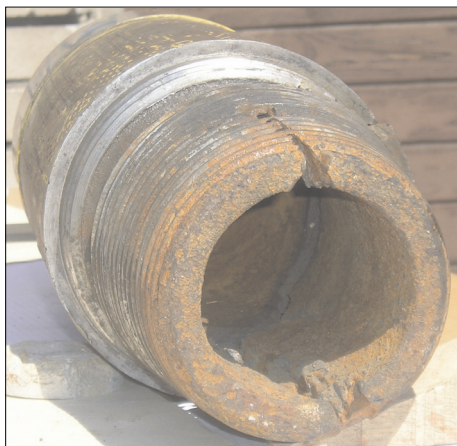
Rys. 8. Czoło końcowe czopa (skorodowane)
