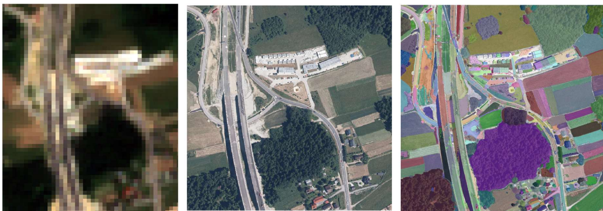
Rysunek 80 Porównanie zobrazowań Sentinel-2 (rozdzielczość 10 metrów) – po lewej oraz ortofotomapy (rozdzielczość 0.25m) – po środku dla tego samego obszaru oraz podobnego czasu akwizycji. Segmentacja obiektów/obszarów z wykorzystaniem segment-geospatial po prawej.
