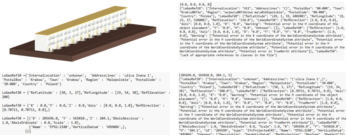
Rysunek 54 Lewy górny róg model testowy; prawy górny róg odczytana georeferencja dla modelu wejściowego; parametry georeferencji do przypisania (lewy dolny róg), prawy dolny róg odczytana georeferencja i poziom po nadaniu georeferencji.
