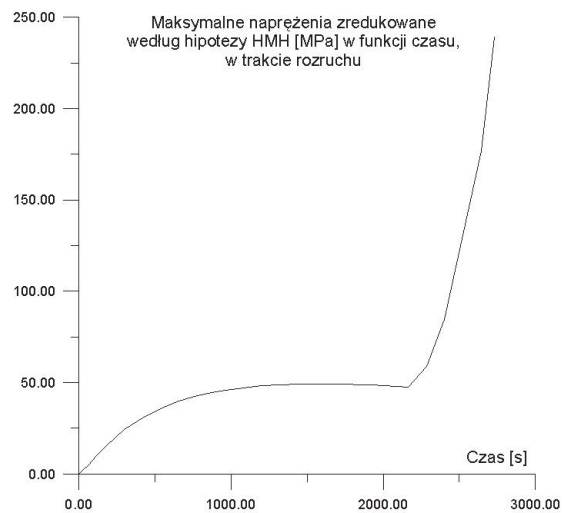
Rys. 12. Maksymalne naprężenia zredukowane w całym połączeniu w funkcji czasu, w czasie nagrzewania
