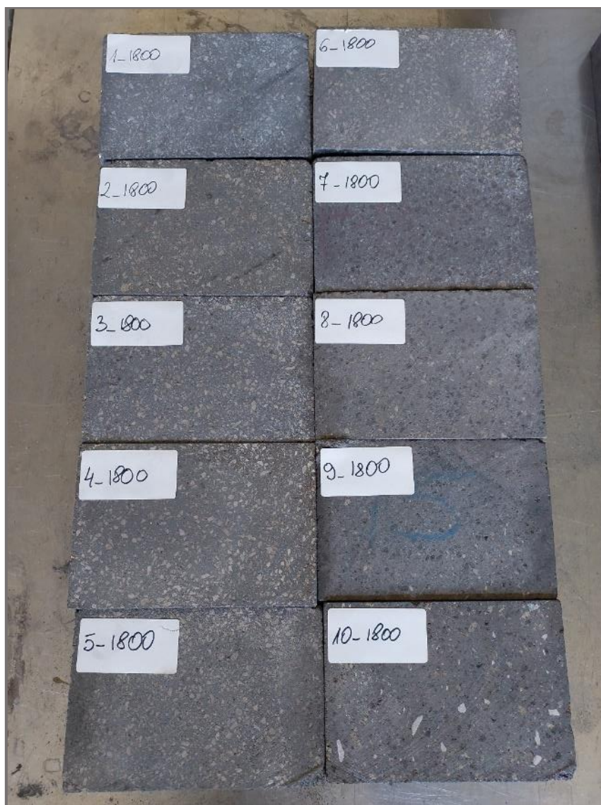
Rys. 23. Fragmenty materiałów MgO-C z których pobrano próbki do przygotowania zglądów do obserwacji mikrostruktury. Numery od 1 do 10 odnoszą się do numeru receptury zgodnej z tab. 8.
