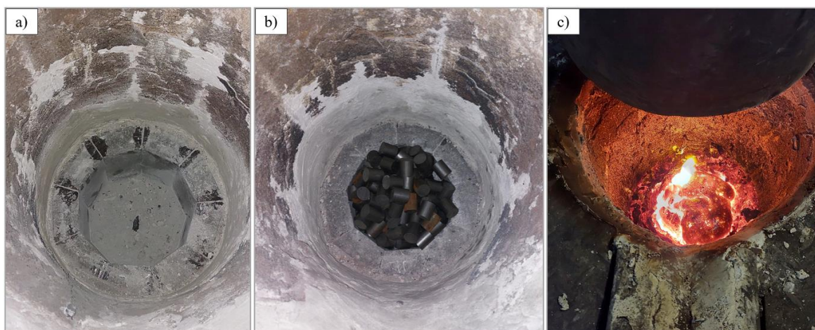
Rys. 37. Widok z góry na piec indukcyjny i testowane materiały. a) zabudowany pierścień z materiałów MgO-C, b) wypełnienie stalą, c) piec podczas pracy z widoczną od góry warstwą żużla.
