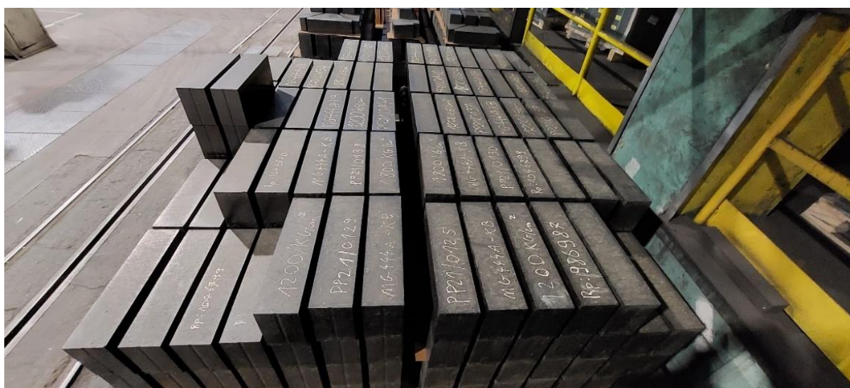
Rys. 17. Część wytworzonych materiałów testowych MgO-C po procesie suszenia bezpośrednio przed sortowaniem.
