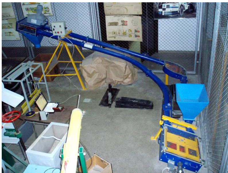
Rys. 8.1. Widok przenośnika zgrzeblowego rurowego f-my Ferind
