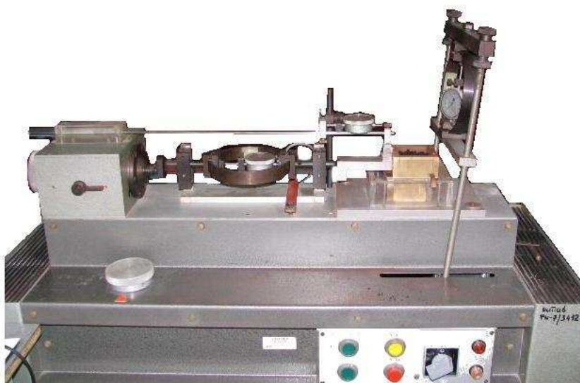
Rys. 7.1. Aparat typu AB do bezpośredniego ścinania próbki materiału
