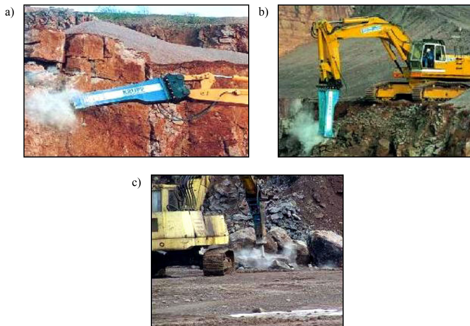
Rys. 2. Widok ciężkich młotów hydraulicznych stosowanych w górnictwie odkrywkowym do: a) urabiania przodka; b) urabiania spągu; c) rozbijania brył nadwymiarowych
