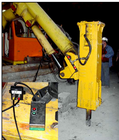
Rys. 8. Widok jednego z młotów ROXON z zamontowanymi przetwornikami ciśnienia, przygotowanego do badań oraz przenośnego rejestratora pomiarowego M2W3
