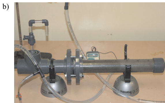
Rys. 1. Przyrząd Kaczyńskiego do oznaczania współczynnika filtracji gruntów spoistych [4, 6]:
