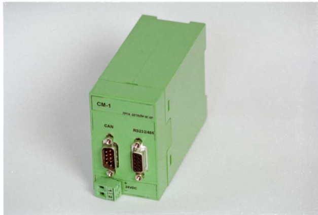
Rys. A.1. Prototyp konwertera protokołów CANpsw/Modbus RTU
